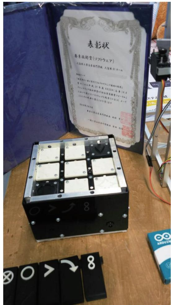
図6 試作した視覚障がい者用プログラミング教材
