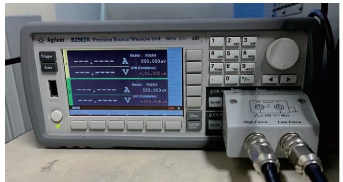
図4 TFT 測定のためのソースメジャーユニット（SMU）
