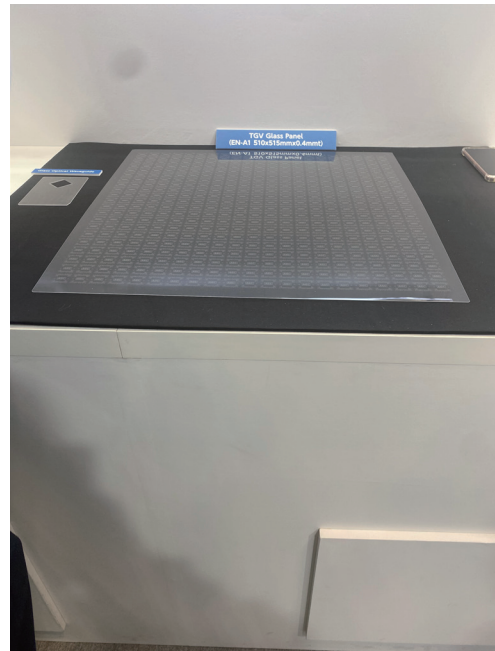
写真4 TGV加工付きのガラス基板(AGC)
