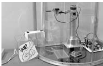
図8 動力線非貫通型搬送 ロボット
