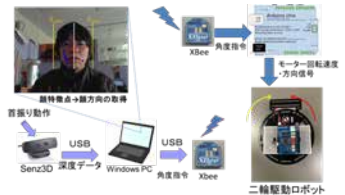
図1 頭部ジェスチャ認識による機械操縦システム図
