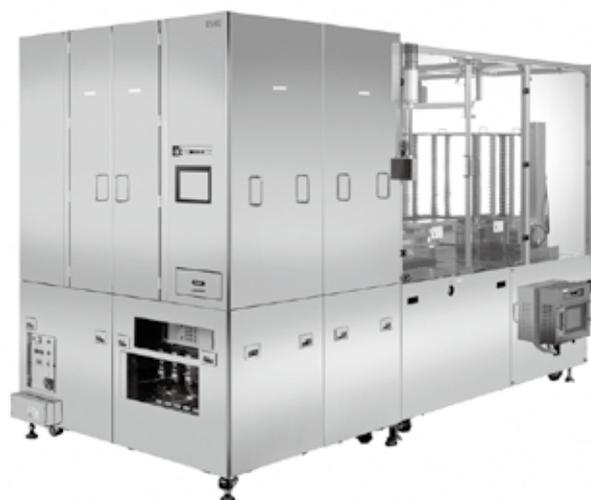
エキシマランプユニット（左）とエキシマ光洗浄装置（液晶基板用：右）
