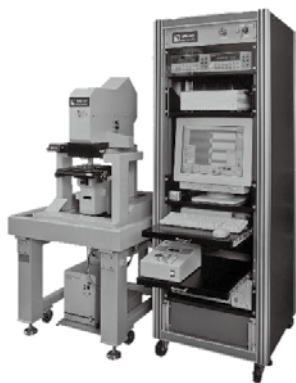
位相シフト量測定装置： 測定波長は、当時の露光機と同一波長の365nm
