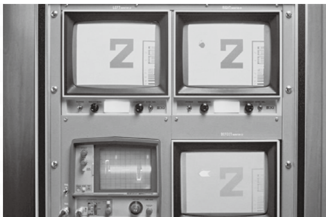
フォトマスク欠陥検査装置のカメラ映像： 右のモニターに欠陥が映っている
