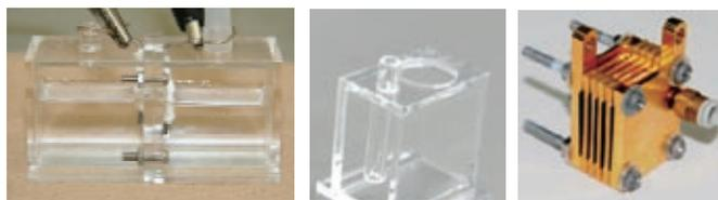
(a) 電解装置 (b) バッファ (c) PEFC
