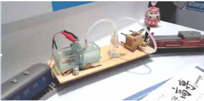
図3 電解装置・燃料電池搭載型鉄道模型
