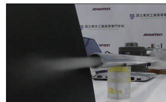
図3 秋田谷君発案ドライアイスによる振動流の可視化風景
