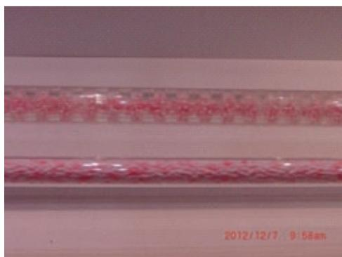
図4 可視化デモ中に見える赤色発泡スチロール粒子（上：溝付管、下：直円管）
